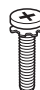
Šrouby stojanu 4EA, M4 x L14 (Pouze LB63**, 39LB65**-ZA/ ZK, 42/47/50/55/60/70LB65**, LB67**, LB68**, LB69**, LB70**, LB72**, LB73**) 8EA, M4 x L14 (Pouze LB86**, LB87**) (Viz str. A-3, A-4, A-6, A-7, A-8, A-9)
