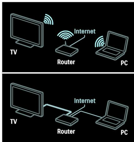
Puede conectar este televisor a la red doméstica mediante una conexión inalámbrica o con cables.
