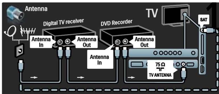
Después, utilice un cable euroconector para conectar el receptor digital al televisor.
