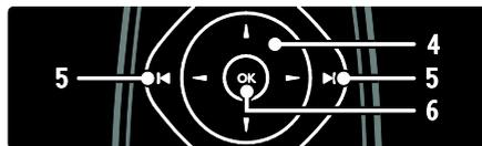
4. **▲▼◀▶** (Botones de desplazamiento): permite desplazarse por los menús y seleccionar elementos.
