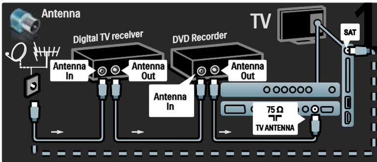
Después, utilice dos cables euroconectores para conectar el receptor digital al grabador de DVD y éste al televisor.
