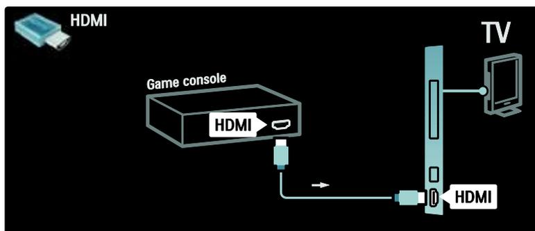
Si no puede utilizar el conector lateral, utilice un cable HDMI o EXT2 (YPbPr y Audio L/R) para conectar la consola de videojuegos a la parte posterior del televisor (en algunos modelos, la salida EXT2 está etiquetada como EXT3).
