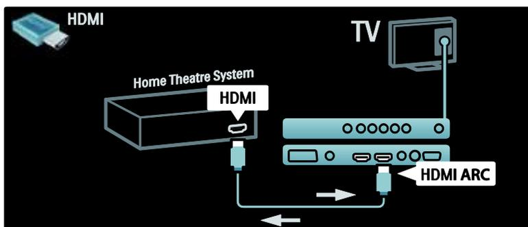
HDMI ARC le permite utilizar Philips EasyLink para la salida de audio del televisor directamente a un dispositivo de audio conectado, sin necesidad de conectar un cable de audio digital adicional. Asegúrese de que el dispositivo es compatible con HDMI-CEC y ARC, y de que el televisor está conectado al dispositivo mediante un cable HDMI conectado a conectores HDMI ARC.
