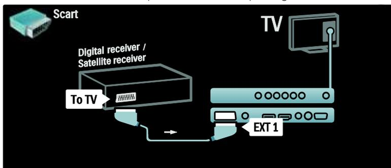
Para finalizar, utilice dos cables euroconectores para conectar los dos dispositivos y el televisor.
