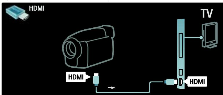
Si no puede utilizar el conector lateral, utilice un cable HDMI o EXT2 (YPbPr y Audio L/R) para conectar la videocámara a la parte posterior del televisor. (En algunos modelos, la salida EXT2 está etiquetada como EXT3).
