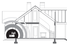
Positionnement inadéquat du routeur
